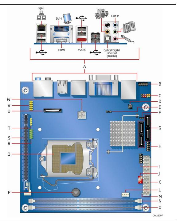
**Figure 1. Intel Desktop Board DH57JG Components**
